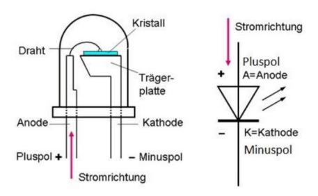
Merke: Beim Durchleuchten einer LED sieht man die dicke Trägerplatte; dies ist immer der Minuspol.
